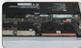
● 单热管双风扇的散热模块
