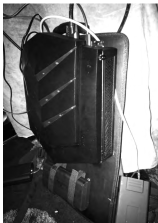
② • 一种为解决VR连线问题的电脑背包，为减轻重量和体积，采用的就是中端显卡GeForce GTX 1060
