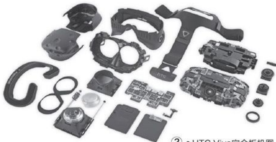
② • HTC Vive完全拆机图
