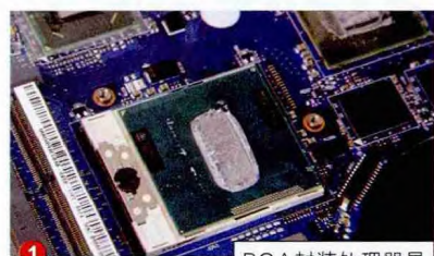
PGA封装处理器是这样的，拧一下螺丝就能将CPU摘下来
