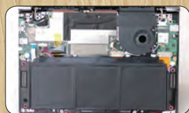
● “蜂鸟”S5-371的内部结构图
