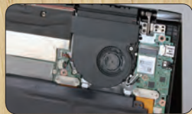
● “蜂鸟”S5-371的散热模块设计
