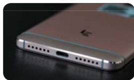
● 乐2用USB Type-C取代了耳机孔
