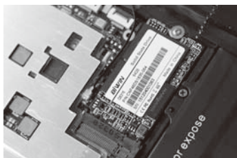
③ • 酷睿M平板或变形本大都配备了M.2插槽，可安装40mm~80mm不等的SSD
