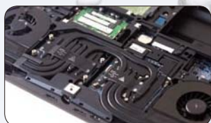
● 豪华的八热管散热模块
