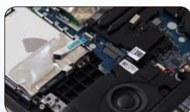
● 预留的M.2插槽，可加装SSD硬盘
