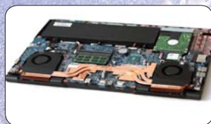
● 双热管双风扇的散热模块
