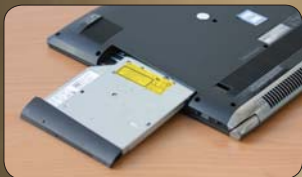
可拆卸的光驱可改装硬盘托架
