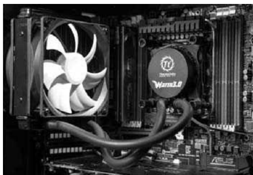
④ • 相对来说一体水冷安装起来更简单，安全性更高
