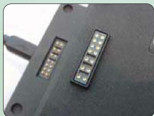
ThinkPad Stack相互连接的奥妙就在这些金属触点上
