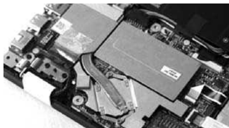
② • 武装赛扬N3150处理器的笔记本内部的散热模块设计
