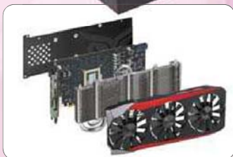
● 通过风扇、热管散热片和金属背板协同散热
