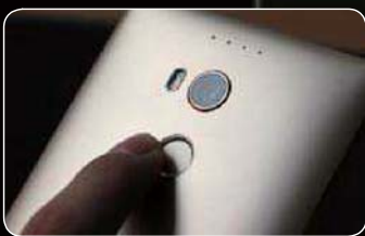
● 后置的按压式指纹识别模块
