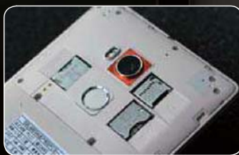
● 拆下后盖即可加装SIM或存储卡
