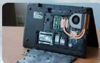
● 简易的拆机升级结构设计
