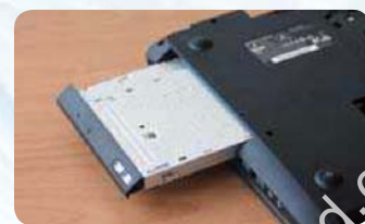
● 光驱可自行拆卸更换硬盘托架
