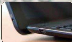
● 底座的Micro USB接口仅能充电
