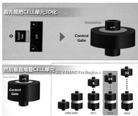
• 3D V-NAND首先将存储单元（CELL）3D化，然后垂直堆叠存储单元
