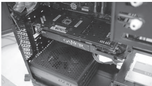
② • 电源风扇朝上时的空气流动方向恰好与显卡风扇相反
