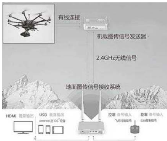
⑥ • 无人机图传系统组成示意图
