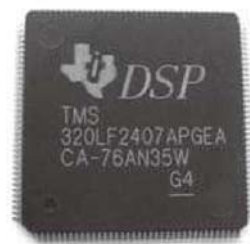
④ • 无人机目前广泛使用的TMS320 LF2407芯片
