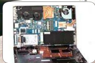
● 3风扇5热管的豪华散热模块
