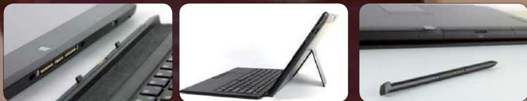
● 底部吸附式的扩展坞接口 ● 连接键盘后就是标准超极本 ● 宇宙版标配的电磁触控笔
