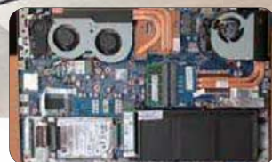
● 三风扇五热管的豪华散热设计
