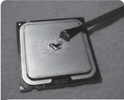
导热系数最出色的液态金属散热材料
