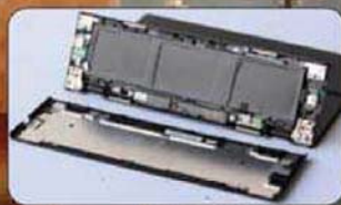
● 与屏幕相连的底座部分容纳了硕大的锂电池
