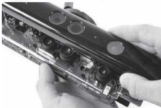
② • Kinect传感器主要组成部分（两个摄像头和一个红外发射器）
