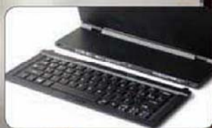
● 原来键盘采用了可以拆卸的设计形式并内置电池
