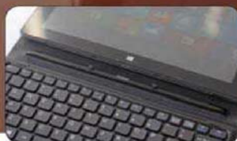
● PCpad与键盘通过底部的扩展坞稳固连接 ● 键盘套的一端可以支撑PCpad扮演支架角色 ● USB3.0接口可直接接驳标准USB外设
