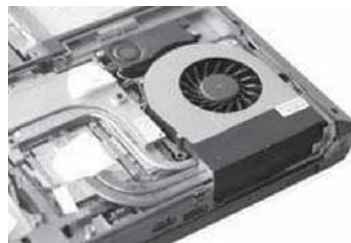
② ● 雷神G150P采用了独立的三热管+风扇负责GPU散热
