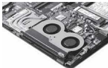
③ ● 神舟战神Z7采用三热管+两个超薄风扇来负责GPU散热
