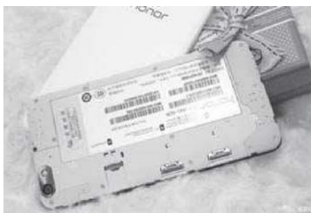
④ ● 背盖可拆但电池无法更换
