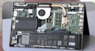
● 产品拆机后的内部结构，升级清灰很容易
