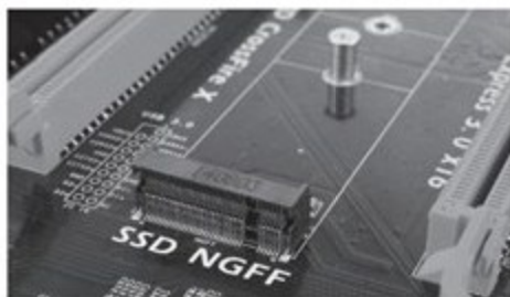
③ • 根据螺丝位决定支持M.2 SSD的长度标准
