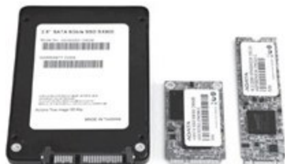
① • 2.5英寸硬盘、mSATA SSD和M.2 SSD大小对比
