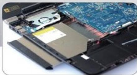
● 内置光驱设计，可用托架安装硬盘
