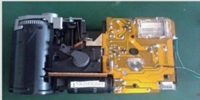
• 拆卸闲置相机内的氙气闪光灯及相关的电路模块
