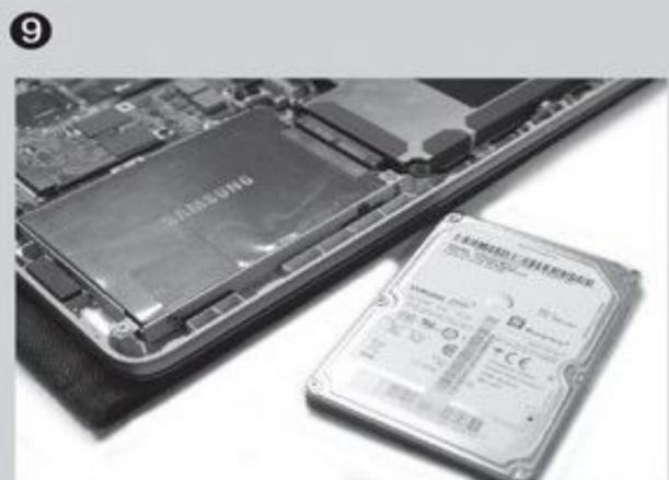
• 将HDD硬盘从固定支架中取出来，再将SSD固定其中即可
