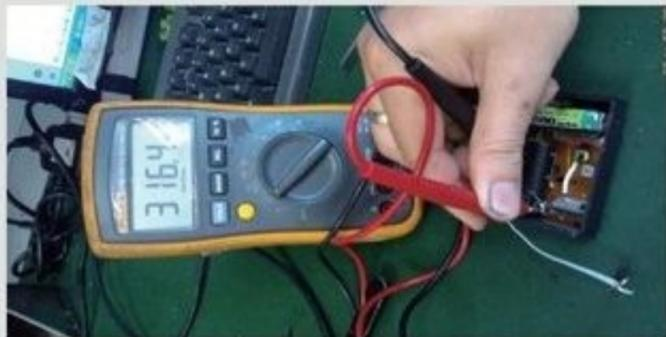
• 测量工作参数，整机充电电流在90ma左右，充满电后的电容电压可达300V左右，这个电压提供给氙气灯使用
