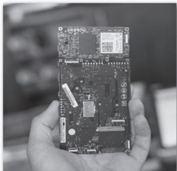
● 蓝色部分为酷睿M平台的主体，绿色部分为SSD固态硬盘和Intel 7260AC无线芯片
