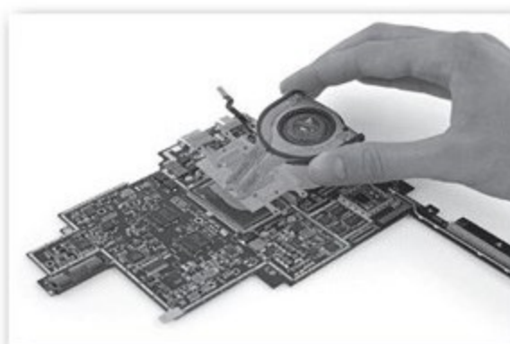
● Surface Pro 3主板与复杂的散热模块
