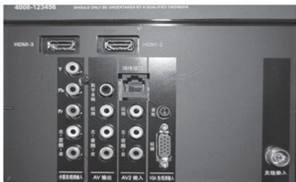
> 早期网络电视配备的网线接口
