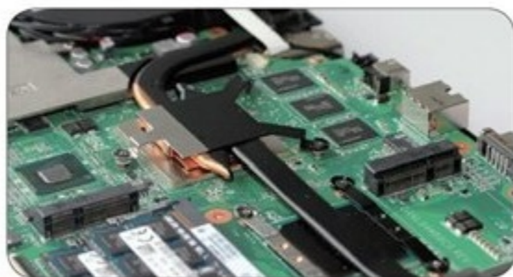
●机器内部配备两个mSATA接口，扩展性出色
