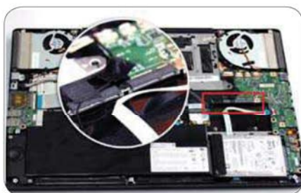
● G7-700内部结构，两个mSATA插槽设计很贴心
