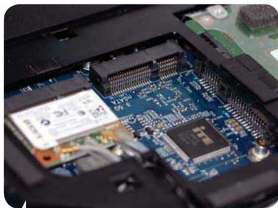
△ mini PCI-E和mSATA插槽外观一致，两张图分别迷你PC机主板和笔记本内部两种接口的对比
