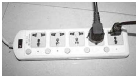
> 插座使用的是独立开关，可以很方便地开关某个接口的供电
