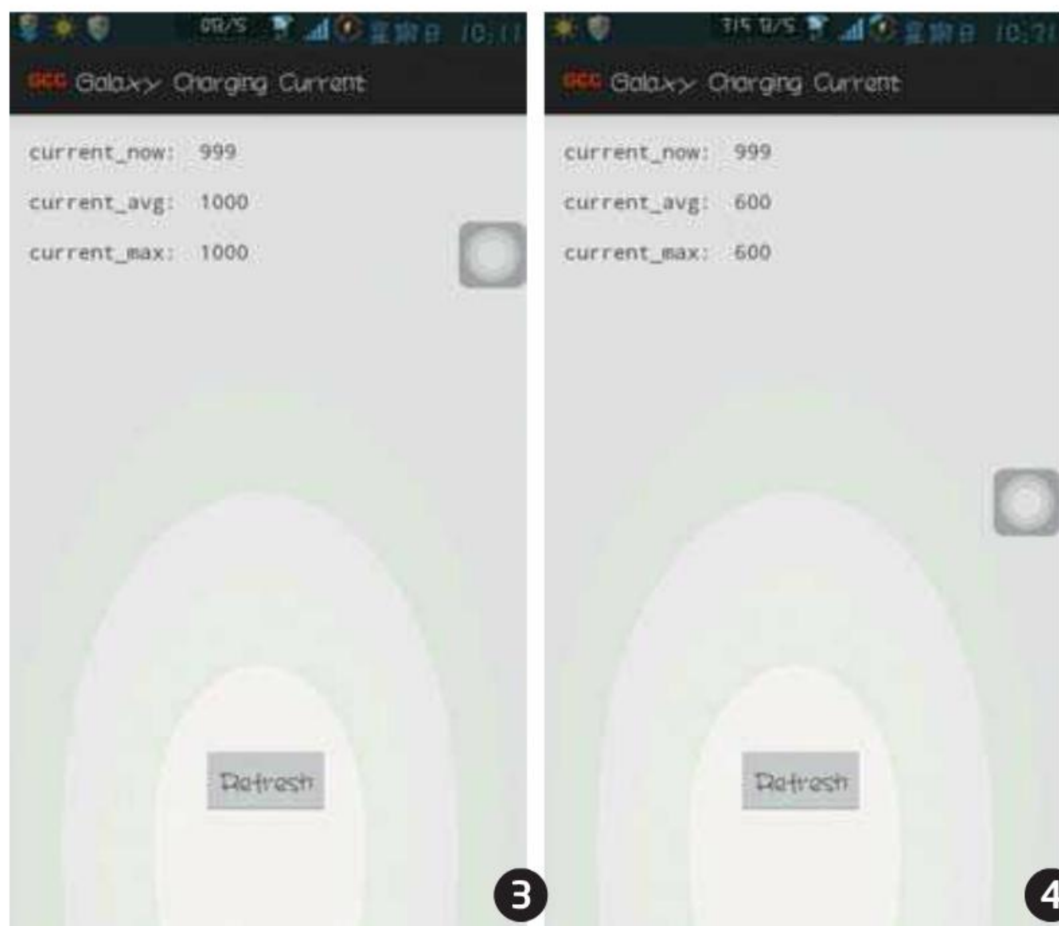
同一款手机分别使用原装和第三方数据线充电时的对比，二者充电效率相差40%
