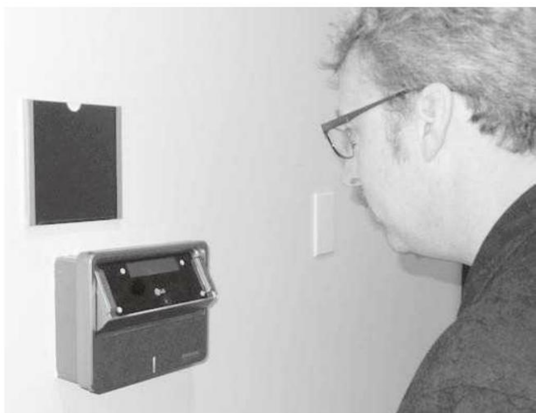
> 这个“双眼相机”守卫着赛门铁克“Vault”的入口。它使用的是LG IrisAccess可移动摄像头，能够自动锁定用户脸部进行识别，定价在3000美元左右
