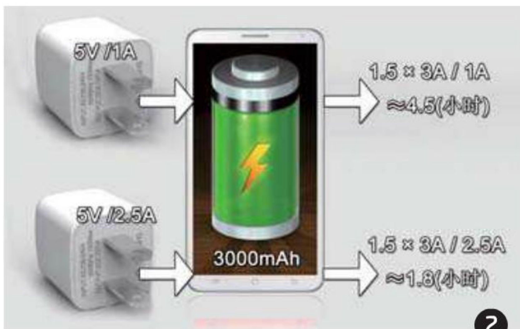
2 充电时间计算公式：1.5 × 电池容量（mAh）/ 充电电流（mA）
