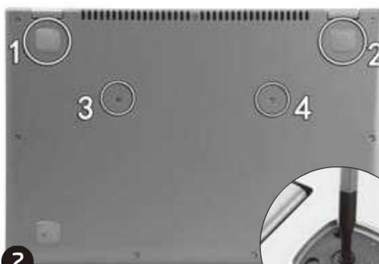
> 隐藏在脚垫里面的螺丝
