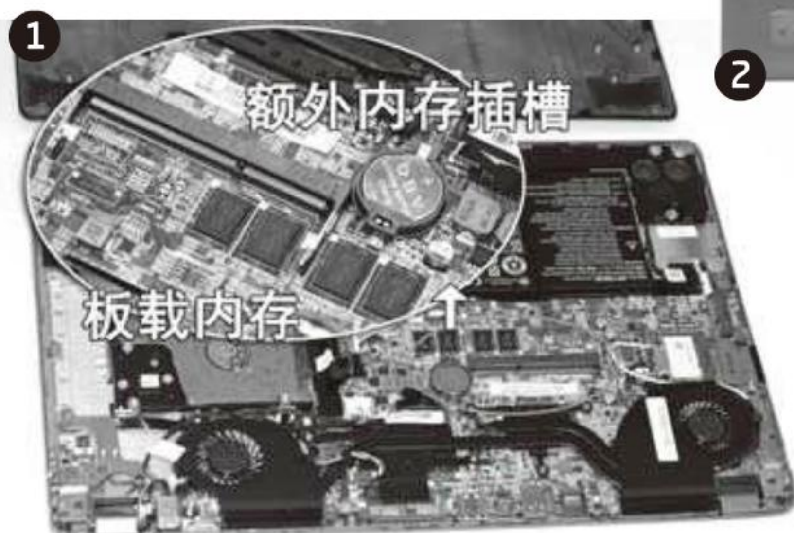
> 采用板载内存 + 额外内存插槽已成为纤薄产品的主流设计
