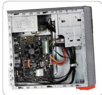
● 华硕M33AA内部结构图
