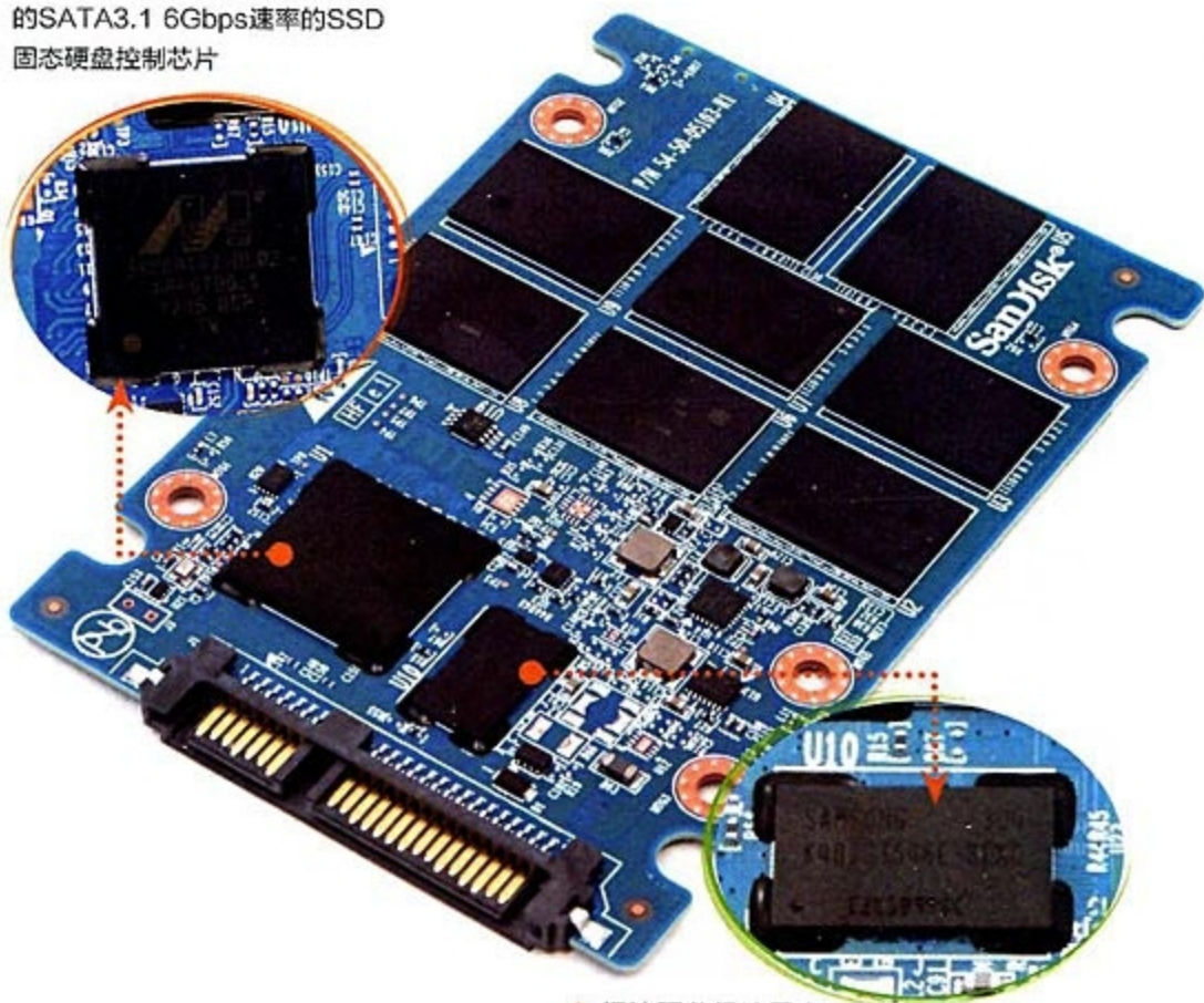
> 闪迪至尊极速固态硬盘内置的缓存芯片
