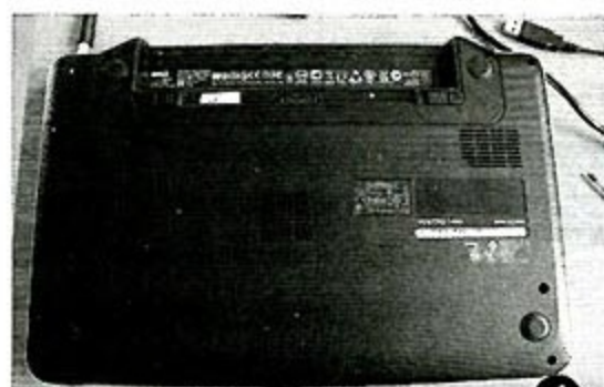
注意电池下边还有两个短螺钉
