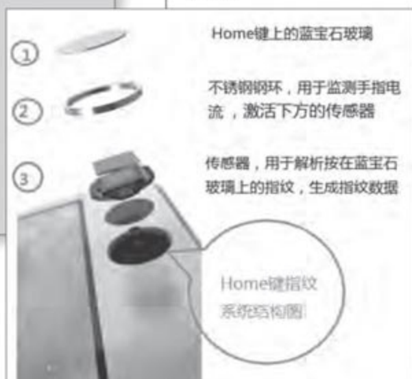
> Home键集成的指纹识别系统分解图
