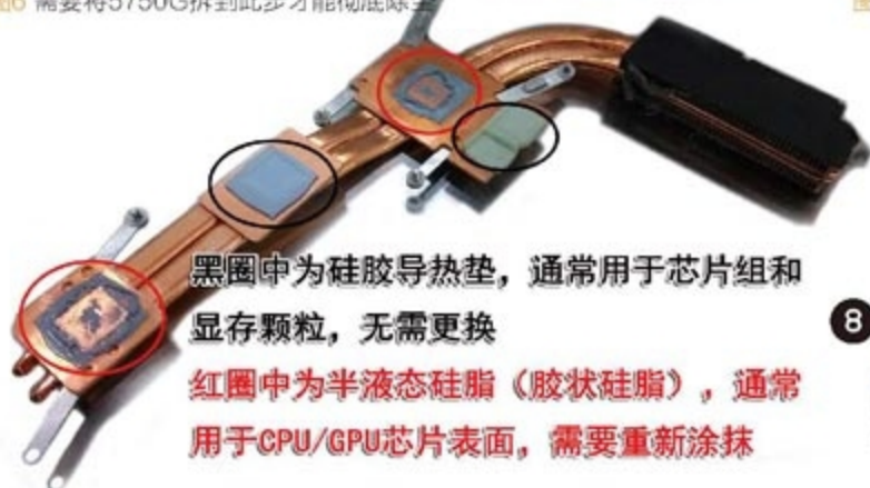
图6 需要将5750G拆到此步才能彻底除尘
