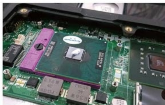
图9 涂抹硅脂要注意适量，太多或太少都会影响散热效果
