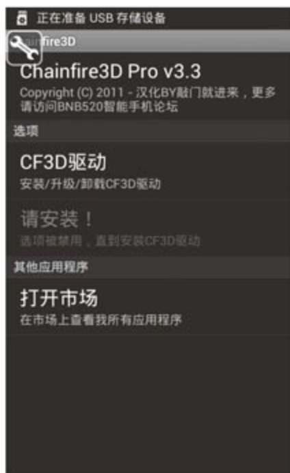
● 打开Chainfire3D 软件，选择CF3D 驱动选项，然后选择安装菜单，机器会自动重启，软件安装成功后，重新打开会看到“安装插件/着色”选项，将各个平台插件安装后，就可以使用了
