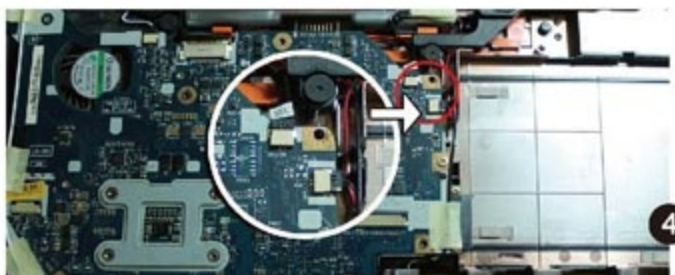
图4 C面的主板由很多螺丝固定，拆卸时还要留意各种排线和电源线的拆装
