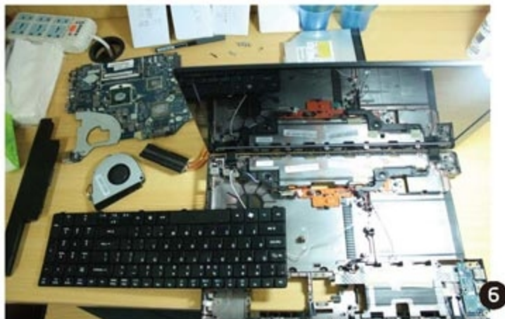
图6 需要将5750G拆到此步才能彻底除尘
