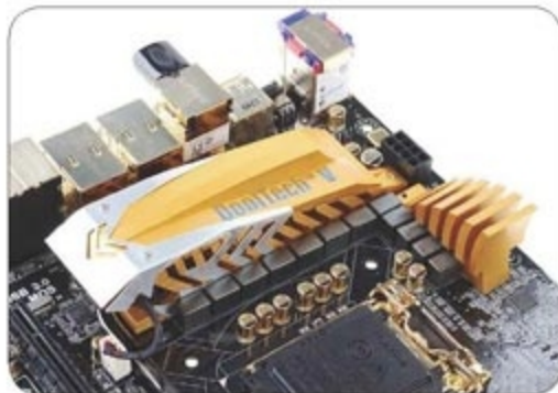
● 被称为QoolTech V的热管配合风扇的主动散热方案
