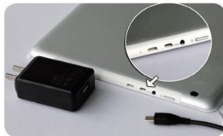
• V973配备Micro USB和Micro HDMI接口，在选购HDMI线缆时要注意接口标准
