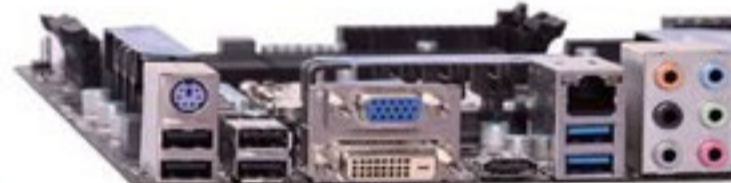
• Hi-Fi Z87X 3D主板提供了完整7.1声道音频输出
