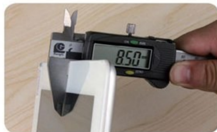
• 用游标卡尺测量V973的实测厚度，8.5mm没有任何水分
