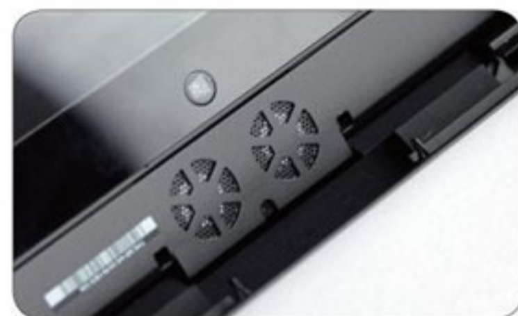
● 隐藏在底座内部的两组小风扇，可以很好地辅助屏幕部分内部的热量排出
