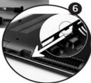
▲ 在安装底壳时要先从藏有暗扣的接口开始，比如A450J的VGA接口边框底侧就有个暗扣，需要先从它开始着手
