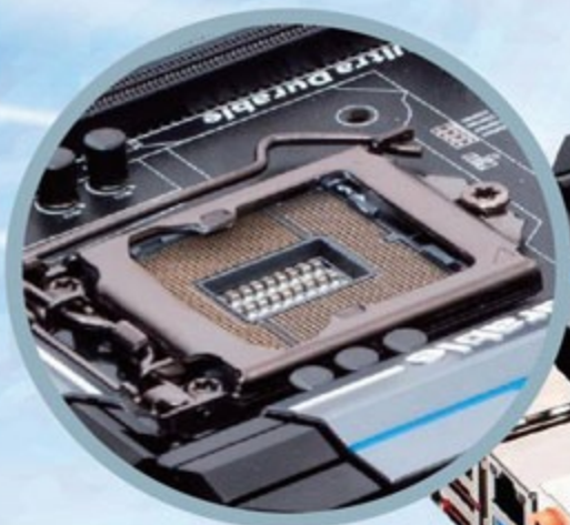
15 μ 镀金的CPU针脚， 可以大大避免CPU针脚的接触不良
