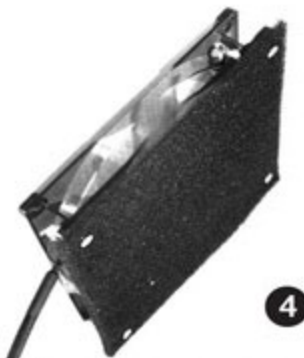
加装防尘棉前，一定要先区分风扇的正反面，否则会影响通风效率的
