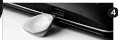
▲ 从接口最少的一侧开始拆机，用撬片沿着缝隙轻轻一划即可，然后握稳撬片顺势沿着机身前端滑动扩大缝隙
