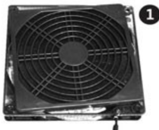
网上所卖的防尘网多为12cm标准，是无法安装在14cm风扇上的，反之亦然
