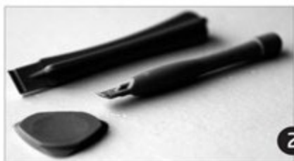
▲ 撬棒和撬片，材质以塑料为主。在淘宝上也有金属材质的撬棒，但仅适合有一定动手能力的用户
