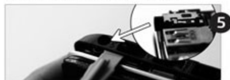
▲ 处理接口的部分就轮到撬棒出场了，需要沿着接口边框底侧往外挑
