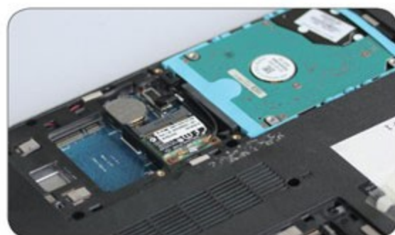
• 闲置的mSATA插槽，以及由软橡胶材质的托架包裹的640GB硬盘
