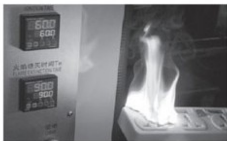
●耐不住高温的排插在极端情况就会起火燃烧，外壳反而成为助燃的材料
