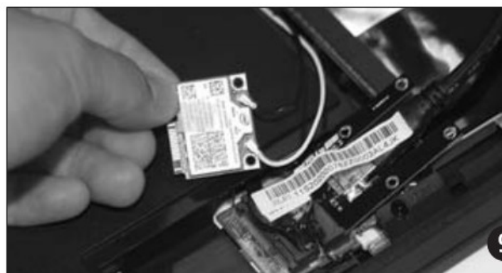
遇到半高的Mini PCI-e插槽就需要剪卡了
