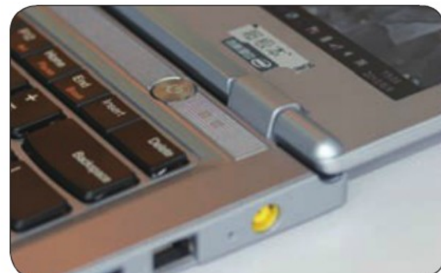
● V490u的屏幕可以实现180度的开合操作，阻尼适中，方便用户在任何环境下使用
