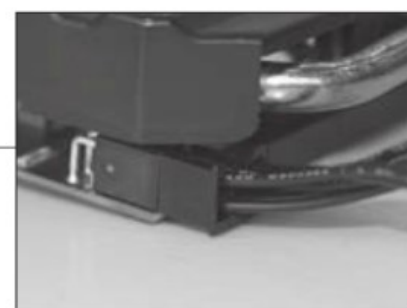
别忘记连接显卡供电线
