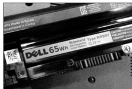
电池容量提升到了65Wh，电池底部的脚垫还能改善新14R的散热效果
