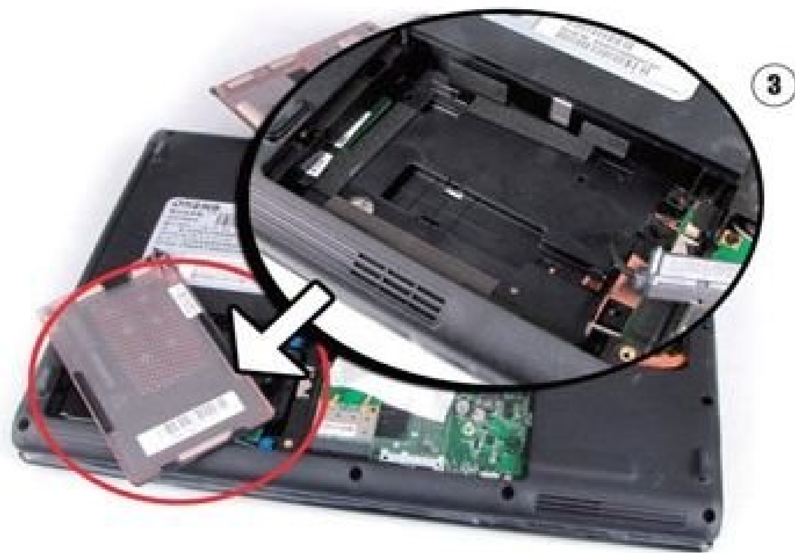
类似的硬盘位设计基本可同时兼容两种厚度的硬盘
