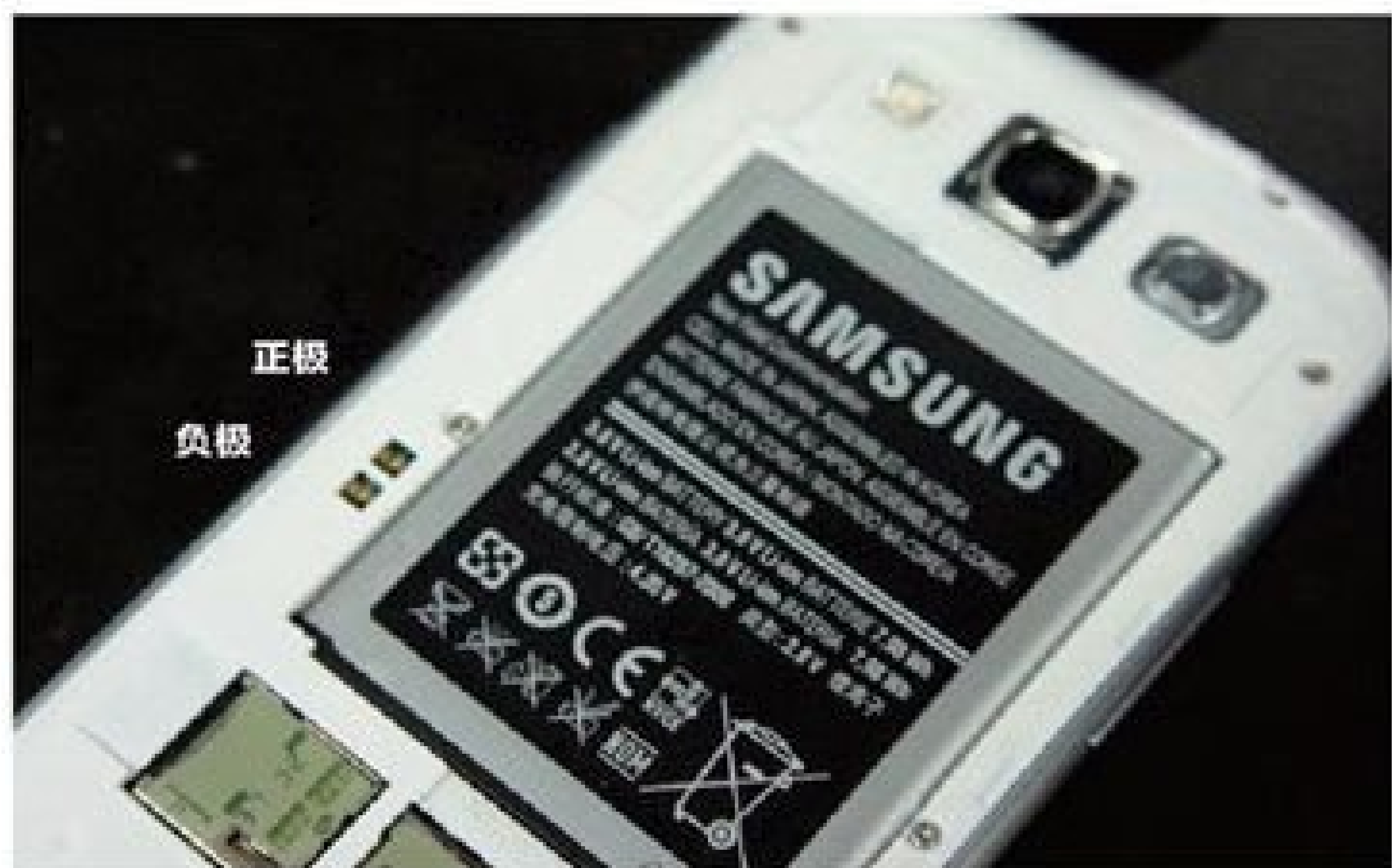
白色导线连接点要连接到手机的正极
