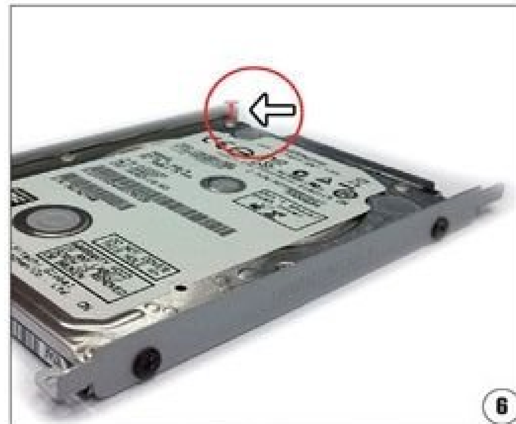
UX42的硬盘托架应该能兼容9.5mm硬盘
