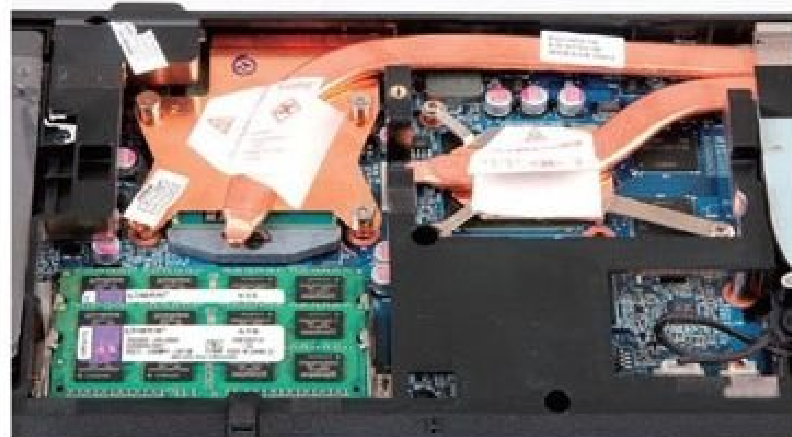
睿频偶尔失效和笔记本内部的散热模块设计的好坏紧密相连
