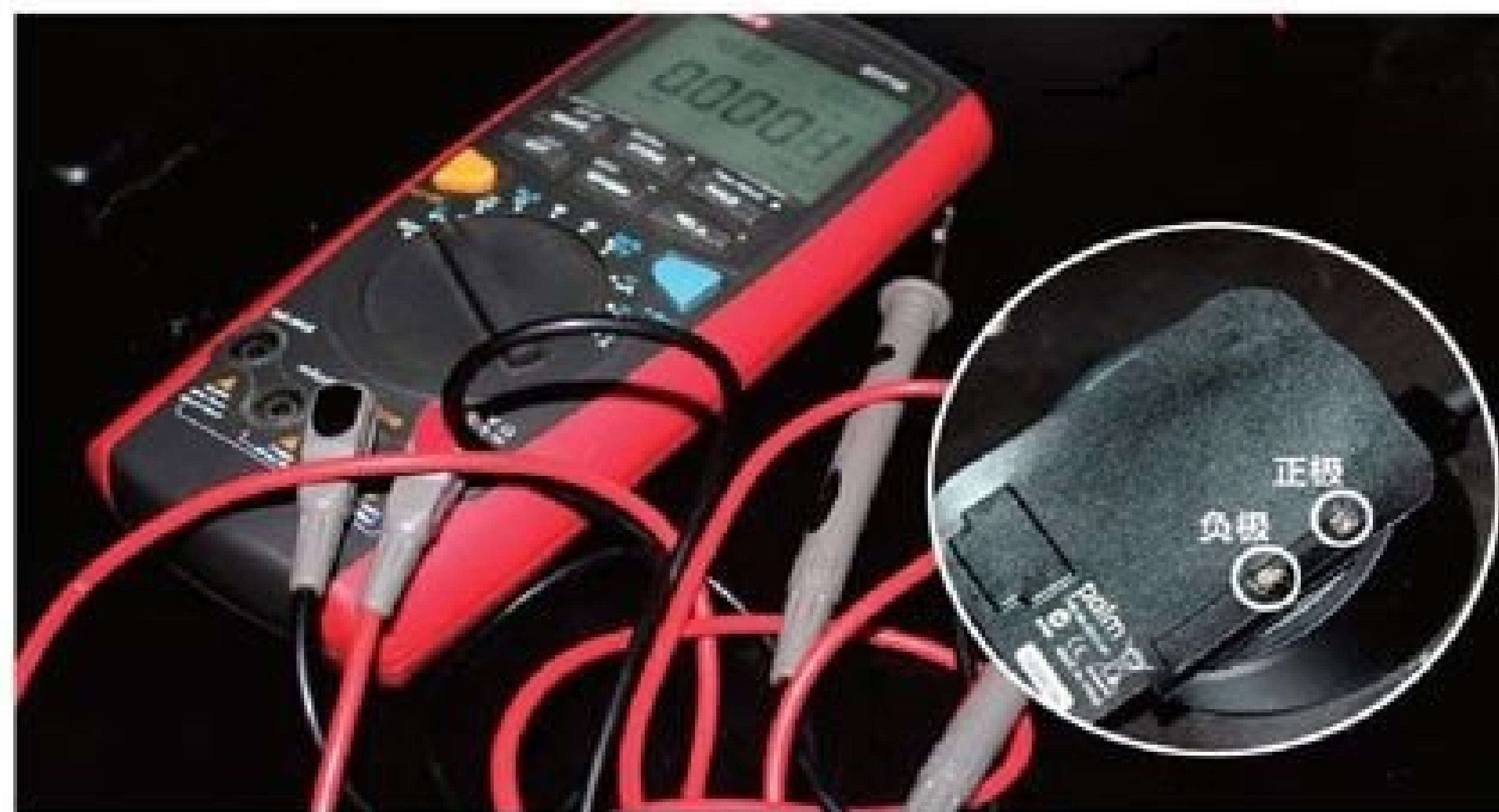
用万能电表来确定金属触点的正负极
