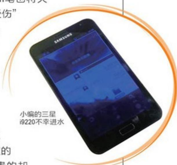
打开淘宝网搜索三星i9220屏幕后发现最便宜的屏幕只需要100多元，但贵的却要1000多元。经过和卖家沟通得知，售价100多元的i9220屏幕只是一块单一的触屏，而1000元左右的屏幕就是大家常说的总成屏，这种屏幕包含触屏、液晶屏、边框、上下喇叭、送话器、USB集成电路板，更换起来比单一的触屏要容易得多。
