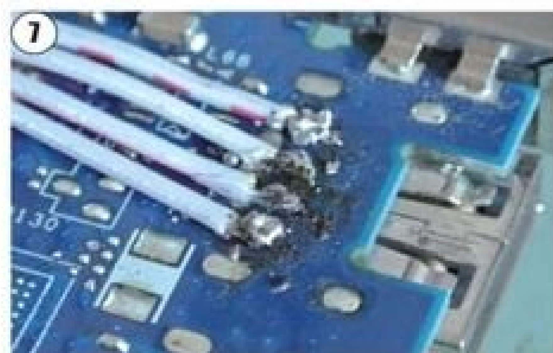
USB供电线的焊接要严格按照线序焊线
