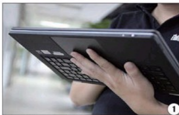
平板模式Yoga的键盘裸露在背面，虽然已经被禁用，但你的手指会一直按在另一侧松软的按键上
