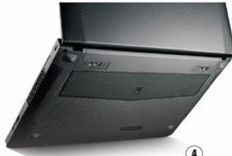
Y400底部改用了更大的金属网面进风口设计
