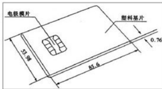
接触式IC卡平面结构示意图
