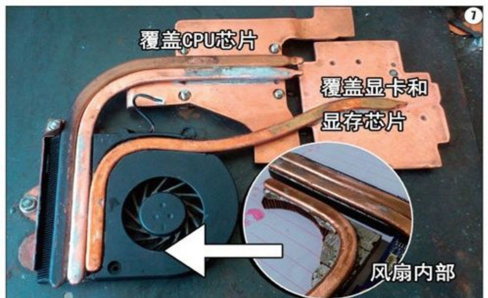
DIY改造散热模组结构解析,全部更换成纯铜的散热材质
