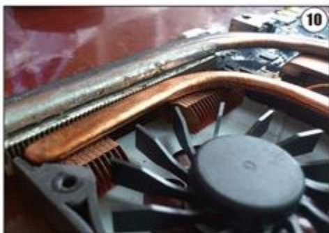
失败的设计，紫铜翅片和导热管的接触面积太小
