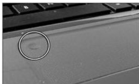
通过触控板左上角的凹陷可以开启/禁用触控功能
