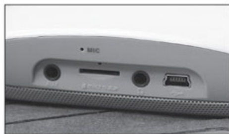
音箱的左端还设计有MIC接口、AUX接口、MicroSD卡槽、耳机接口以及USB接口
