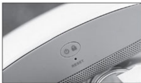
音箱的右侧设计有开关及锁屏按键
