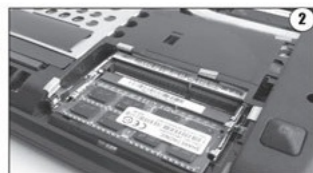
联想Y485的内部结构，仅标配1根内存，推荐自行升级到双4GB
