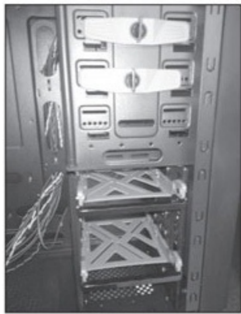
光驱和硬盘位免工具设计
