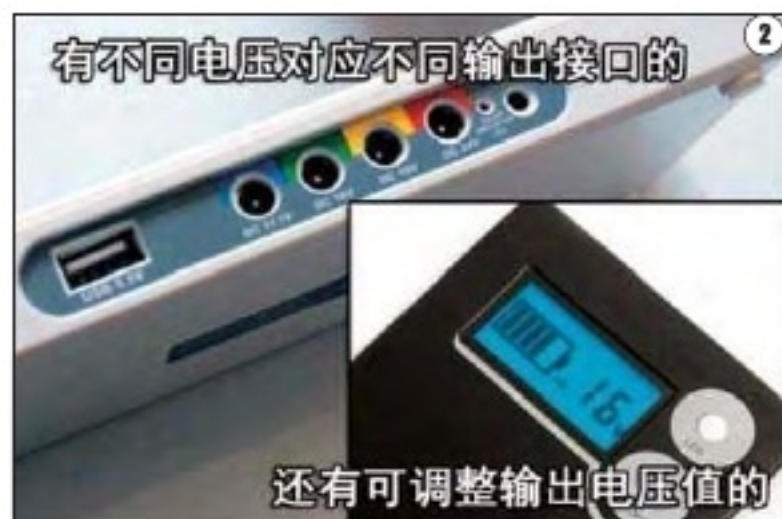
图2 这类移动电源通常可在5V~19V之间调节，不同电压分别对应手机、上网本和普通笔记本等产品
