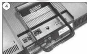
4 机身背部的扩展接口，支持VGA输入和HDMI输出功能
