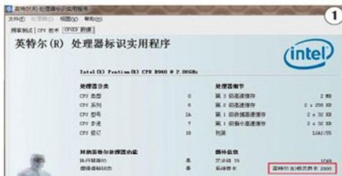
英特尔处理器识别实用程序检测B940内置的为HD2000核心显卡
