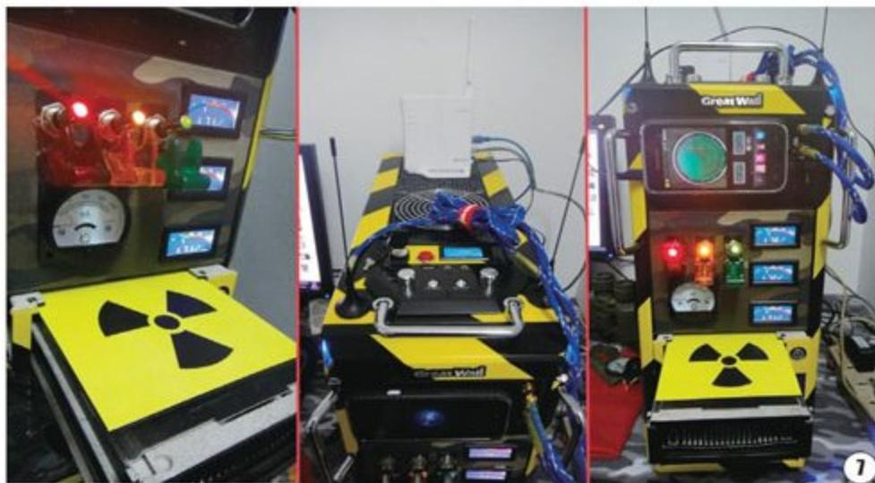
突出军事主题的同时也不乏实用性,监控主机内部三大件的温度和开关内部散热器。底下的三个光驱位安装12cm散热器,镶嵌了核辐射镂空标志为硬盘散热。当然,顶部镶嵌的I9000手机也不单纯只是起点缀作用。除了安装雷达扫描时钟界面、载入使命8的壁纸图和提取游戏过场视屏之外,还能通过小米系统的文件共享和主机互相传输数据,并且安装了向日葵远程控制,方便远程控制主机(图7)。
