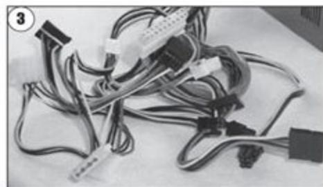
3 接口丰富，全面支持PCI-E 6+2PIN转6PIN
