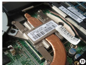
▲更换处理器，需要拆下覆盖在CPU表面的散热片和导热管
