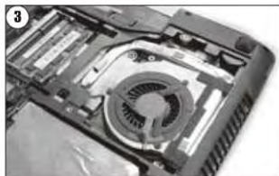
Y470P内部的散热结构，两条纯铜热管确保散热效果
